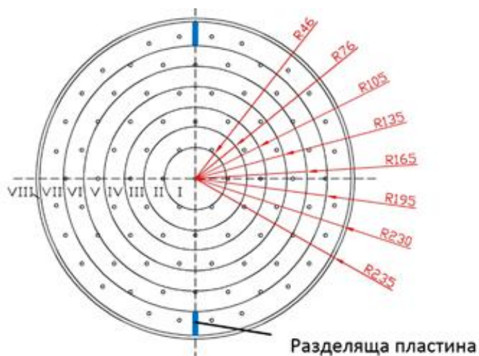
Фиг.3 Събирателно устройство за течността с 8 концентрично разположени цилиндри с проекции на 85 броя отвори за оросяване за начално подаване на течната фаза по напречното сечение на колоната
