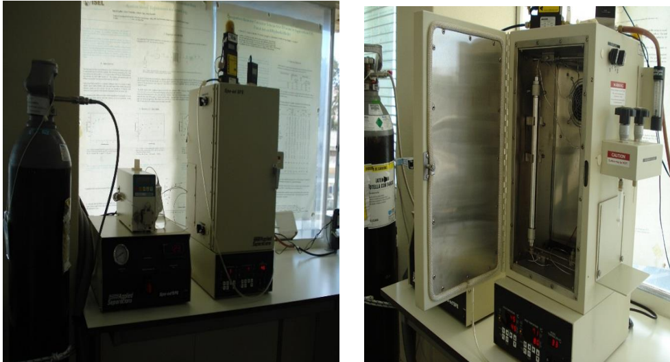
Фиг. 6. Снимка на апаратурата за свръхкритична екстракция в ISEL-Lisbon.
